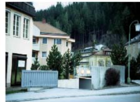
Abb. 5.8: Einfahrt einer Tiefgarage, die durch ein Schwenktor gegen Wassereintritt gesichert werden kann (Quelle: die.wildbach); aus [9]
