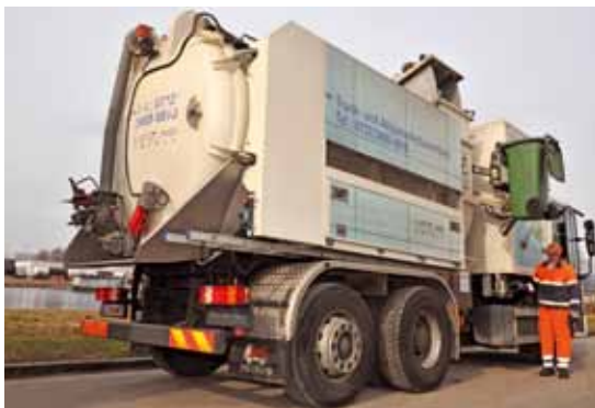
Umleersystem – Reinigung und Desinfektion der Sammelbehälter vor Ort (Foto: Linz AG)
