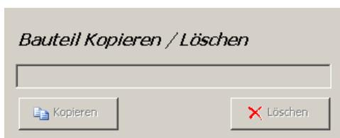
Beim Kopieren eines Bauteiles wird der zu kopierende Bauteil auf der linken Seite markiert. Mit Mausclick auf „Kopieren“ wird der kopierte Bauteil unter dem markierten hinzugefügt.
